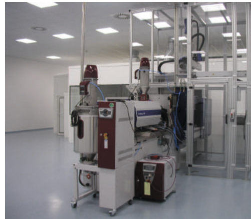
Spritzgussanlage im Reinraum/ injection moulding for clean room
